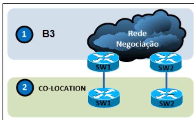
Do ponto de vista lógico, as duas conexões à rede de trânsito para negociação são ponto a ponto com padrões de endereçamentos IPs fornecidos pela B3 e máscara de rede 30. Nesse perímetro, é premissa a configuração do protocolo BGP para comunicação do ambiente de instituição com a rede de negociação da B3.
